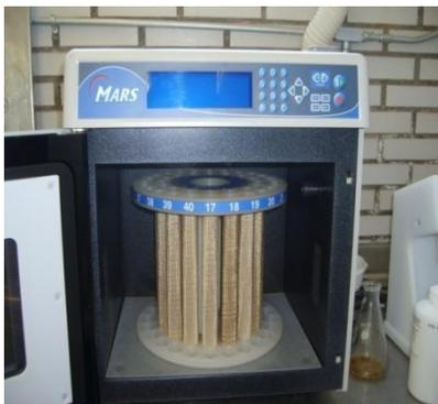
Todas las muestras de alimentos (forrajes, concentrados y premezclas minerales), y agua se procesarán en un digestor de microondas (modelo MARS Xpress, CEM Corporation, Matthews, USA).
